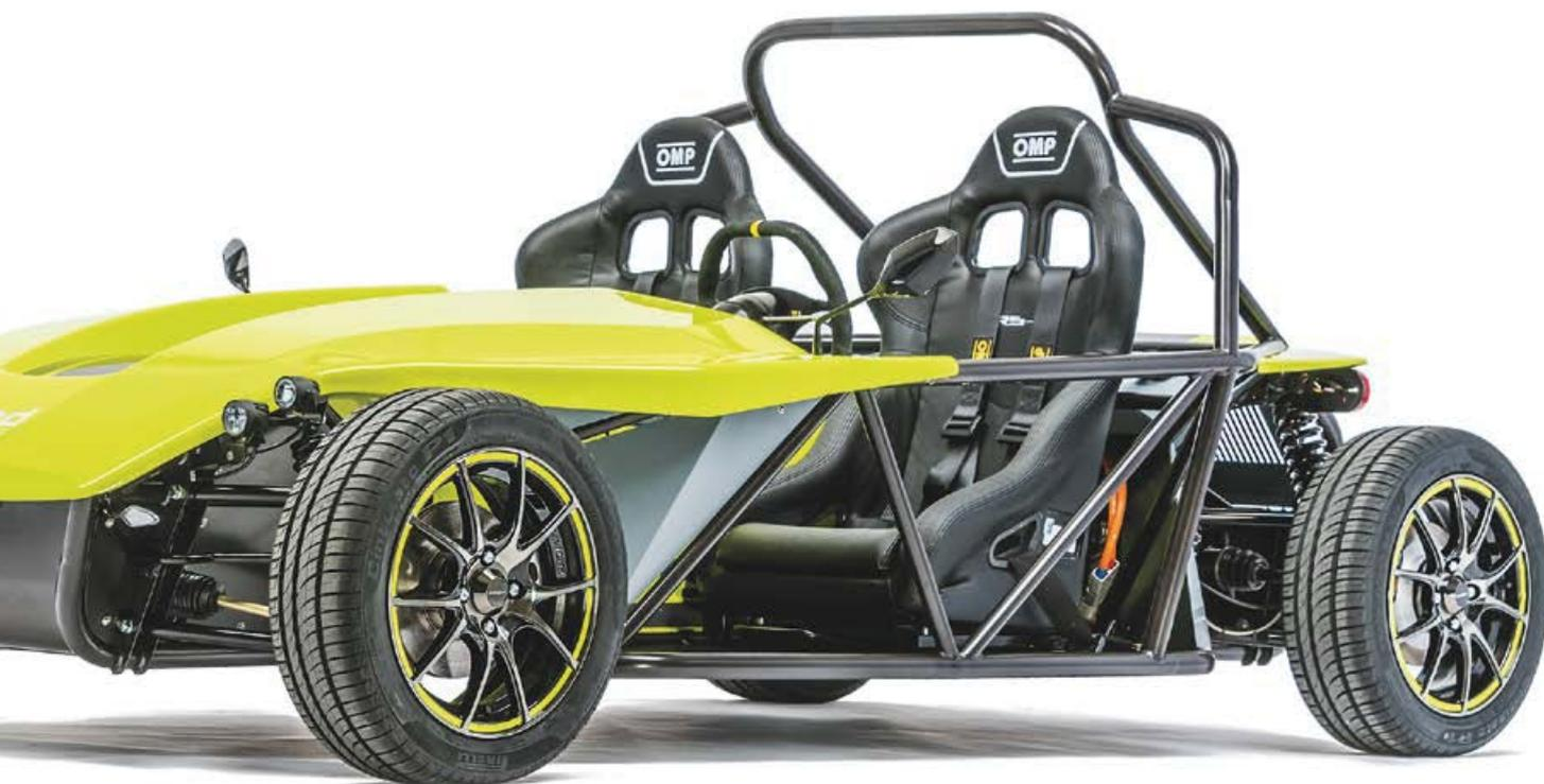
**N**euestes Baby ist der Elektro-Roadster „eRod“. Das sportliche Fun-Car, das man selbst zusammenbauen kann, hat bei 600 kg Gewicht ein Drehmoment von 140 Nm und legt mit einer Batterieladung bis zu 130 km zurück. Die Race-Version des Fahrzeugs, die über 150 kW verfügt, hat sogar eine Reichweite von über 200 km.
