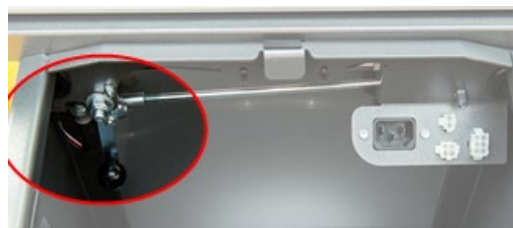
Posizione 2: freno di stazionamento attivato, il veicolo è pronto per la guida.
