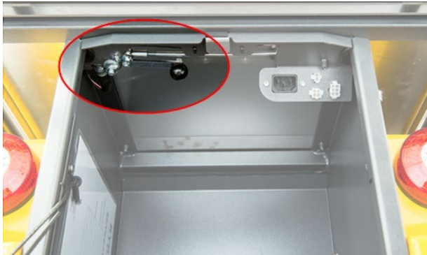
Position 1: frein de stationnement relâché, le véhicule peut être poussé.
