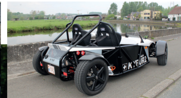
L'eRod n'est pas un jouet : l'arceau évite de se faire mal en cas de retournement.
