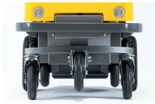
Stufensteigen dank zusätzlichen Steigrädern
